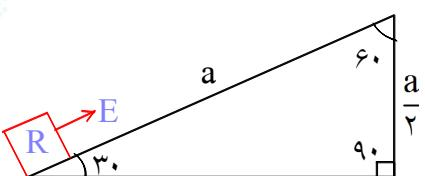
$$2 = \text{مزیت مکانیکی} \Rightarrow \frac{\text{طول سطح (بازوی محرک)}}{\text{ارتفاع سطح (بازوی مقاوم)}} = \frac{a}{\frac{a}{2}} = \frac{2}{1}$$
