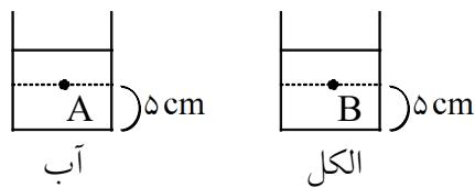
۴۵- دو ظرف با شکل یکسان داریم (مطابق شکل). در یکی از ظرف‌ها  $50\text{cc}$  آب و در دیگری  $50\text{cc}$  الكل ریخته‌ایم. به نظر شما فشار در عمق مایع در هر دو ظرف یکسان است؟ پاسخ خود را توضیح دهید. (ارتفاع هر دو ظرف یکی است).
